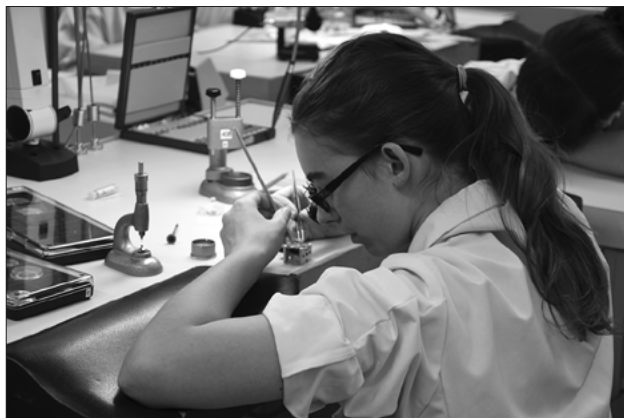
Fig. 1 : Une apprentie de première année assemble et ajuste un mouvement mécanique simple, en se servant d'une cheville de bois et de brucelles, dans la classe d'une école d'horlogerie.
